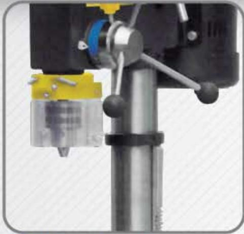
El taladro de columna es una herramienta que facilita el mantener una perfecta verticalidad de la broca al realizar el orificio en metal, madera o plástico y ejercer una presión uniforme durante todo el proceso de barrenado.
